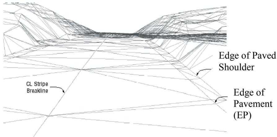
**A DTM MODEL USING THE TIN METHOD**
